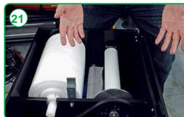
... und setzen Sie die Einweghaspel ein. Filterpapier einsetzen VI.
